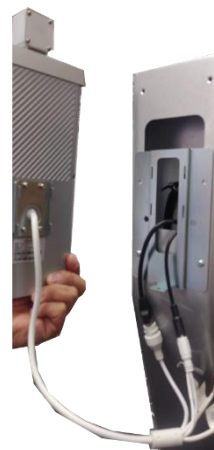
LANケーブルと電源を接続する
