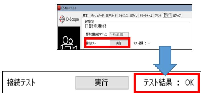
④. 接続テスト「実行」を押します。警告灯への接続ができている場合は、テスト結果：OKと表示されます。
